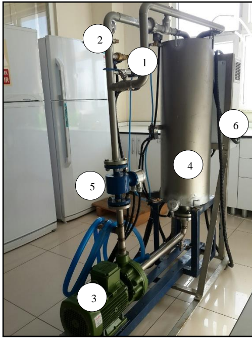
Şekil 3.2. Ön arıtma deneylerinde kullanılan hidrodinamik kavitasyon deney düzeneği (1.By-pass hattı, 2.Venturi hattı, 3.Monopomp, 4.Reaktör, 5.Debimetre, 6.Kontrol paneli, 7.Venturi yapısı)
