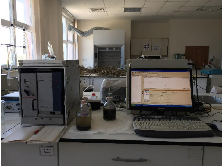
Şekil 3.4. Gaz kromatografi ile BMP şişesi içerisinde gaz kompozisyonu ölçümü
