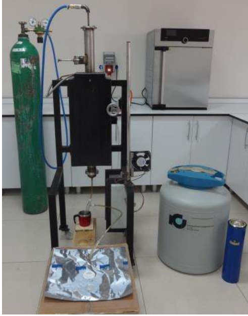
Şekil 3.3. Hızlı piroliz deney düzeneğinin görünüşü.
