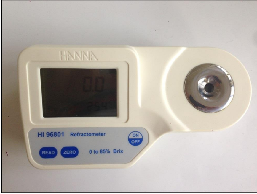
Şekil 3.7. Hanna HI 96801 dijital refraktometreye ait bir görünüm
