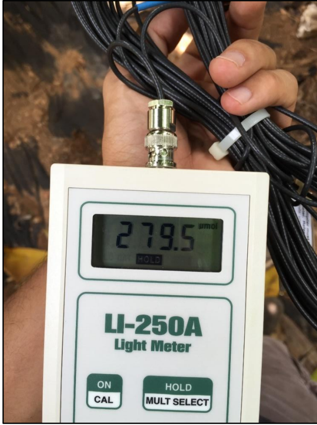
Şekil 3.6. LI-250A marka ışıkölçerden bir görünüm
