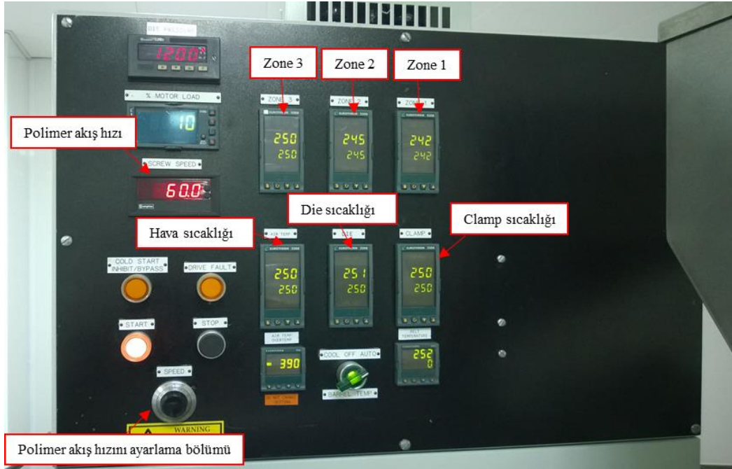
Şekil 3.2. PBT ve PA-12 polimerinin lif çekiminde kullanılan melt blown cihazının kontrol paneli
