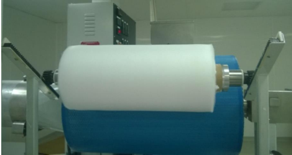
Şekil 3.4. Melt blown cihazı kullanılarak elde edilen PBT lifi
