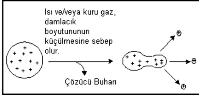
Şekil 2.24. Taylor koni oluşumu ve sonuç olarak izleyen iyon fişkıması
