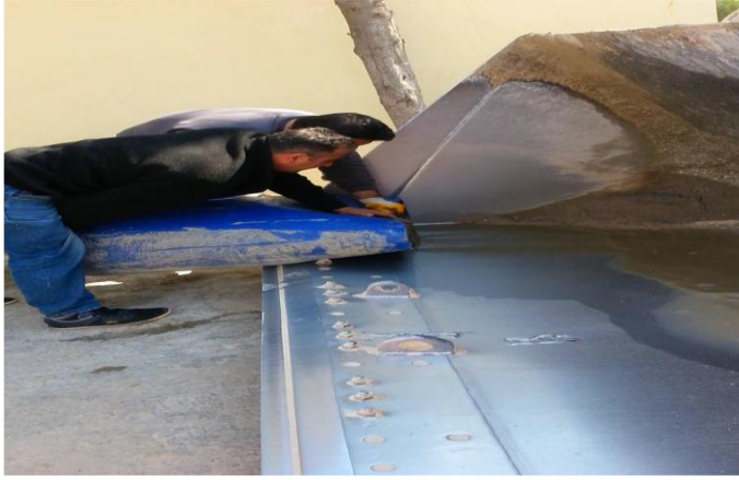
Şekil 3.3. Atık betonun çimento-su karışımından süzdürülmesi
