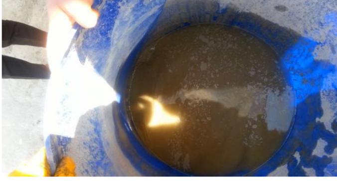
Şekil 3.2. Atık betonun çöktürülmesi
