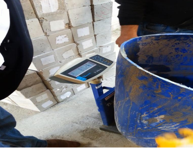
Şekil 3.4. Çimento-su karışımı süzdürülen atık betonun tartılması
