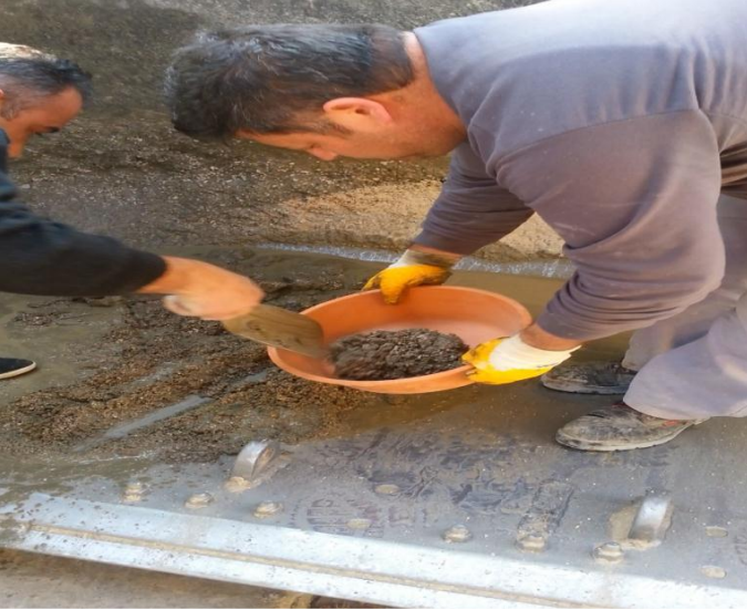
Şekil 3.5. Atık betondan numune alınması
