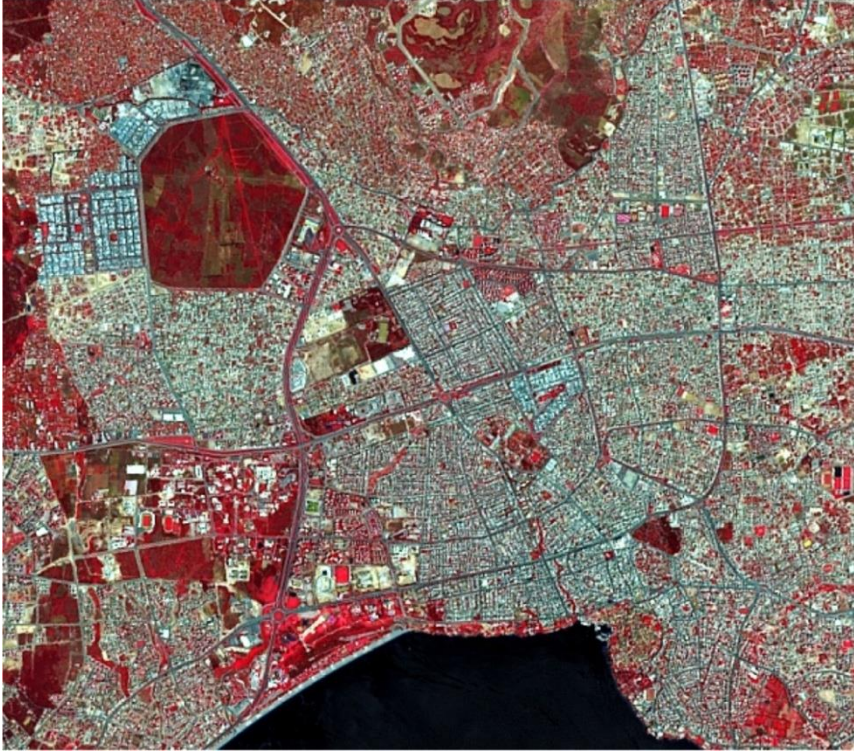
Şekil 3.15.a) Keskinleştirme işlemi öncesi 30 m mekânsal çözünürlüklü Landsat 8 OLI görüntüsü, b) Keskinleştirilmiş, 15 m mekânsal çözünürlüklü Landsat 8 OLI görüntüsü
