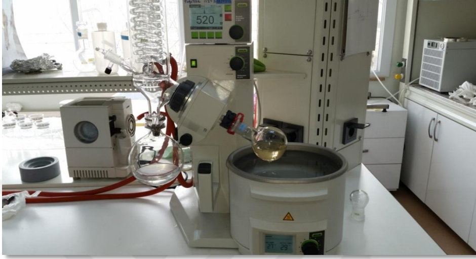
Şekil 3.5. Döner buharlaştırıcı ile deriştirme işlemi
