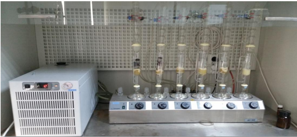
Şekil 3.4. Soksalet ile ekstraksiyon işlemi
