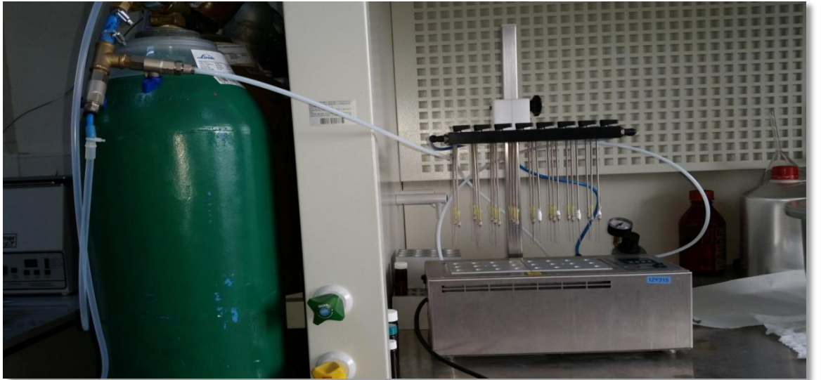
Şekil 3.6. Azot gazı ile deriştirme işlemi
