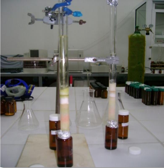
Şekil 3.7. Alümina kolonu ile temizleme işlemi
