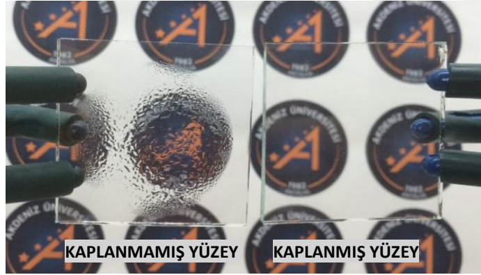
Şekil 4.17. Oda sıcaklığında su emme-buğulanma testi sonrası 44 No'lu kaplamaya ait beher testi görüntüsü
