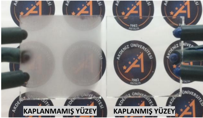
Şekil 4.20. 44 No'lu kaplamaya ait nefes testi testi görüntüsü
