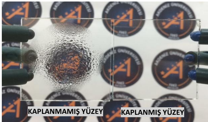
Şekil 4.18. Kaynar su emme-buğulanma testi sonrası 44 No'lu kaplamaya ait beher testi görüntüsü
