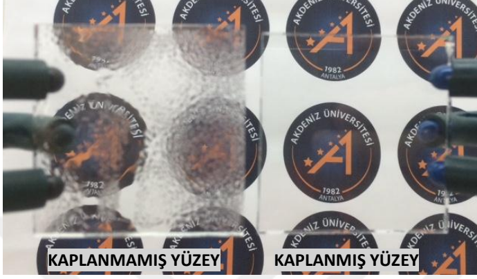
Şekil 4.19. 44 No'lu kaplamaya ait buğu testi testi görüntüsü
