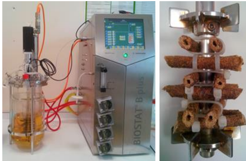
Şekil 3.1. Sartorius stedim Biostat B Plus Biyoreaktör ve biyofilm materyali
