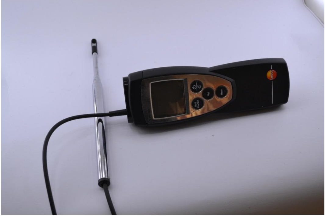
Şekil 3.13. TESTO 425 marka bir hız ölçüm cihazının görünümü
