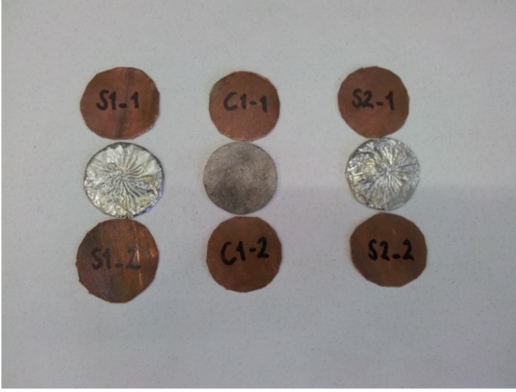
Şekil 3.4. Kalay numuneleri (S1, S2), referans materyal (R1) ve akı monitörleri (S1_1, S1_2, S2_1, S2_2, R1_1, R2_2)
