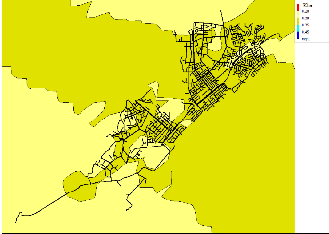
Şekil 4.44. Pilot çalışma bölgesinde 21.07.2010 tarihinde saat 23:00 için tahmin edilen serbest bakiye klor konsantrasyonlarının mekansal değişimi (TÜBİTAK 2011)
