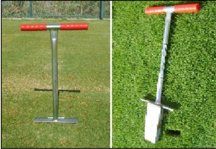
Şekil 3.8. Profil örnekleyicisi (Turf Tech-MPS2- S)
