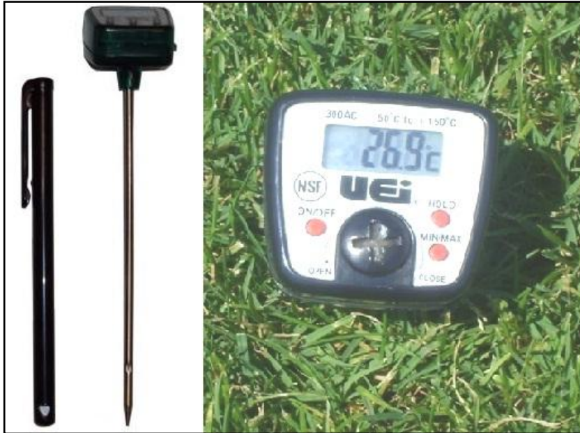
Şekil 3.15. Toprak sıcaklığı ölçümü aleti (Turf tech - DPT1C- dijital termometre)
