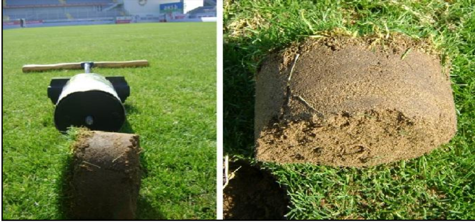
Şekil 3.11. Çim blok kesici aleti ile çıkarılan çim bloğunda çim sıklığı belirlenmiştir
