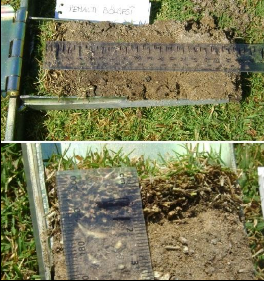
Şekil 3.9. Kök derinliği ve keçe tabakası ölçümü
