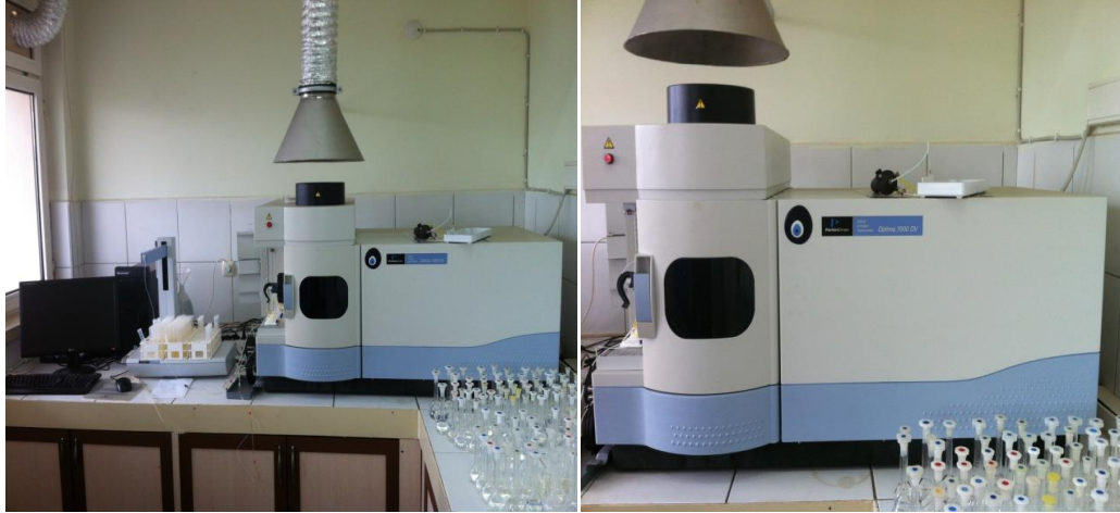
Şekil 3.11. Makro element ve mikro element okumalarının yapıldığı ICP-OES cihazından genel bir görünüm
