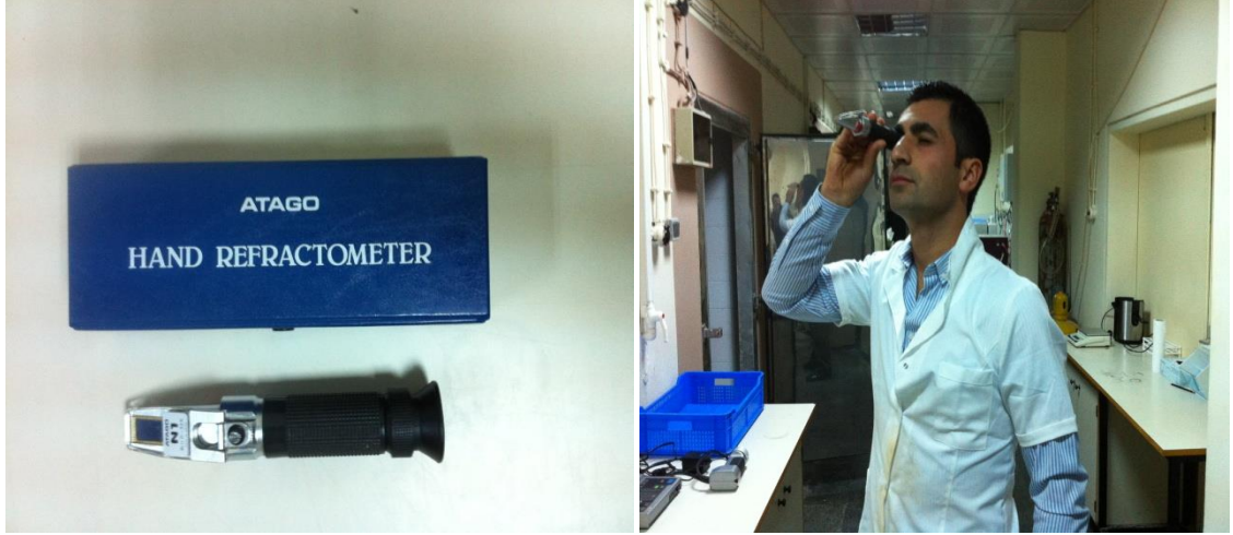
Şekil 3.20. Suda çözünebilir kuru madde miktarının ölçümünün yapıldığı refraktometre ve ölçümün yapılmasından genel bir görünüm
