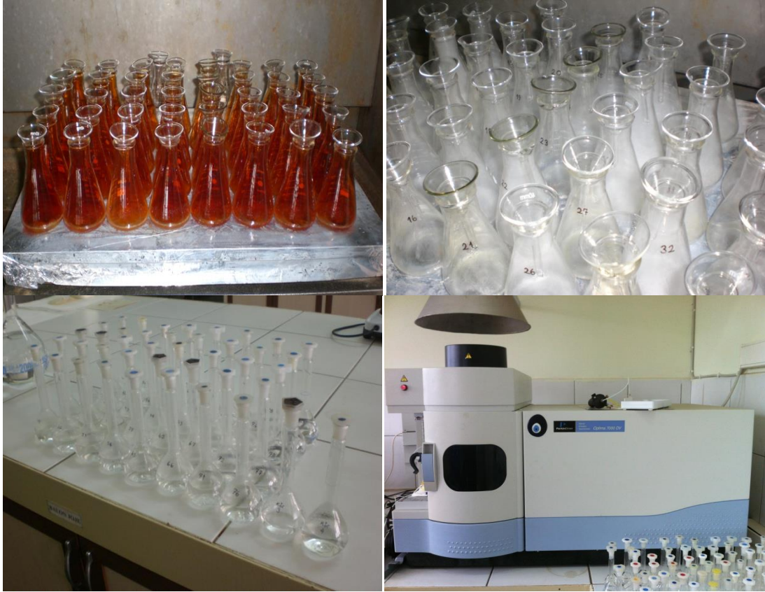
Şekil 3.15. Meyve ve yaprak örneklerinin yaş yakma metodu ile yakılarak ICP-OES cihazında okunmaya hazır hale getirilmesinden genel görünüm
