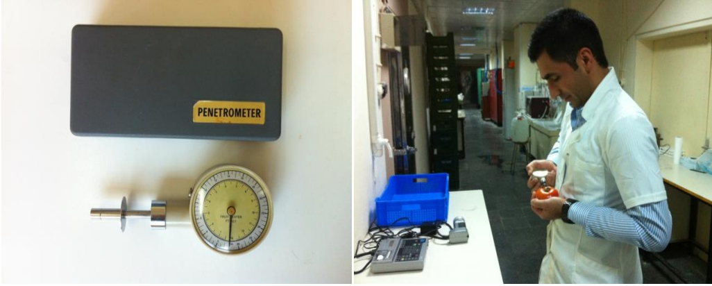
Şekil 3.22. Meyve eti sertliğinin ölçüldüğü penetrometre ve ölçümün yapılmasından genel bir görünüm
