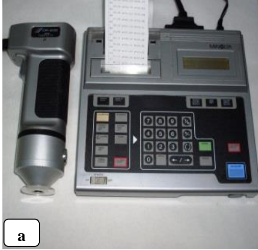
Şekil 3.17.a Meyvelerin renk ölçümünün yapıldığı kromametre
