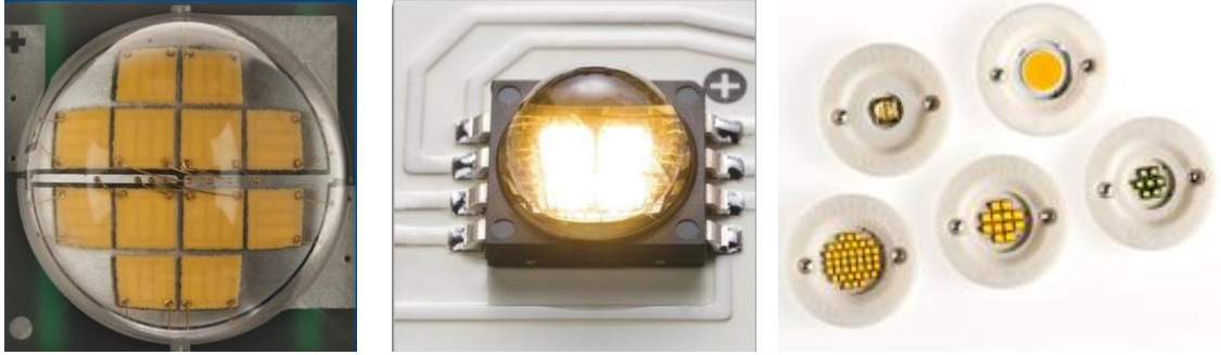
Şekil 2.29. Yüksek güçlü LED modüller (Cree inc. 2012)
