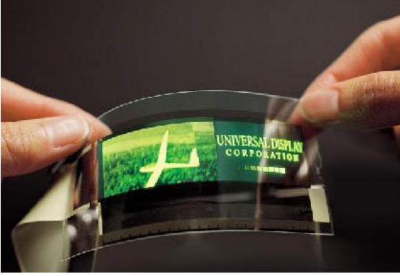
Şekil 2.28. OLED kıvrılabilir ekran (MIT Technology Review 2007)
