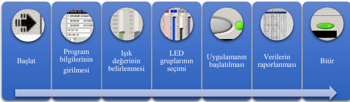
Şekil 3.45. Otomatik aydınlatma programı uygulama adımları
