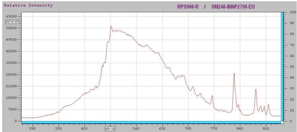
Şekil 3.15. Atmosferik filtreler (AM0 ve AM1) sonrası güneş simülatörü spektrumu
