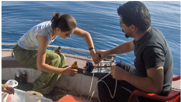
Şekil 3.8. Deniz suyu numunelerinin alınmasında kullanılan numune alma cihazları
