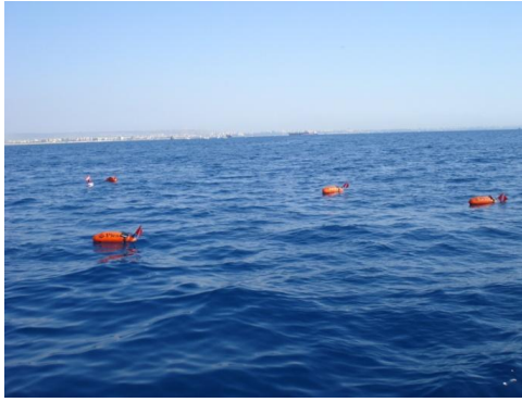
Şekil 3.3. Akıntı ölçümlerinde kullanılan yüzekler (Muhammetoğlu vd 2011)
