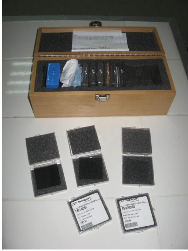
Şekil 3.16. Deneylerde ışık şiddetinin ayarlanması amacıyla kullanılan nötral yoğunluk filtre seti
