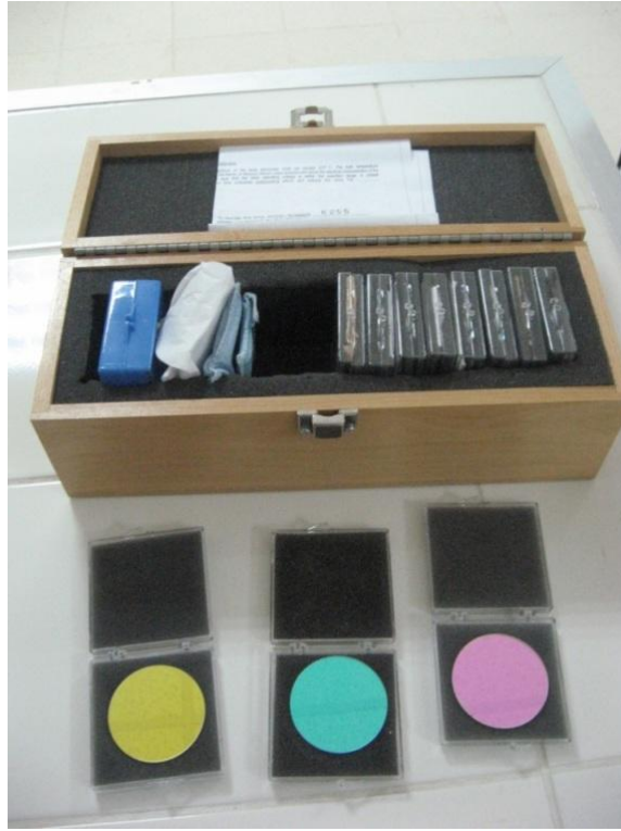
Şekil 3.19. Değişik dalgaboyları için yapılan deneylerde kullanılan dalgaboyu filtreleri
