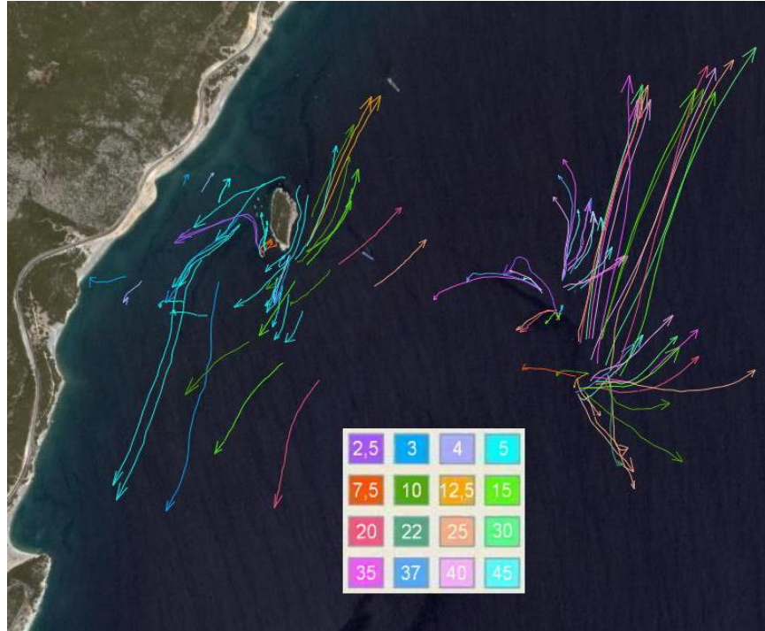
Şekil 4.11. Ölçüm boyunca çeşitli derinliklerde bırakılan yüzeklerin izlediği yollar (derinlikler metre cinsindedir) (Muhammetoğlu vd 2011)
