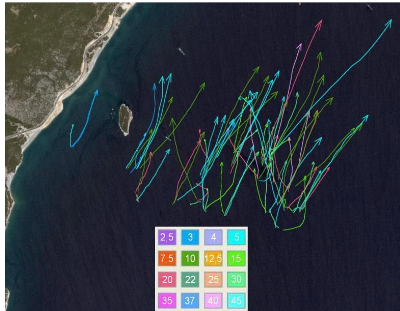
Şekil 4.17. İlkbahar mevsimi ölçümü boyunca çeşitli derinliklerde bırakılan yüzeklerin izlediği yollar (Göstergede verilen derinlikler metredir)
