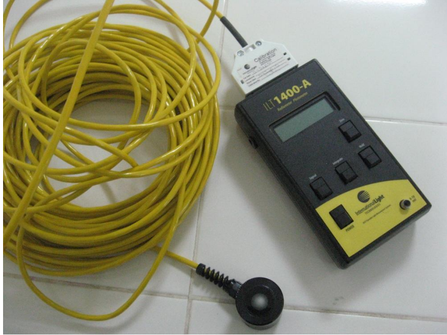
Şekil 3.17. Deneylerde simüle edilen ışığın şiddetini ölçmek için kullanılan radyometre
