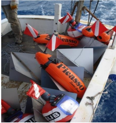
Şekil 3.4. Akıntı ölçümlerinde kullanılan yüzekler (Muhammetoğlu vd 2011)
