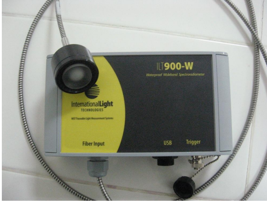
Şekil 3.20. Farklı dalgaboyları için yapılan deneylerde kullanılan spektrometre
