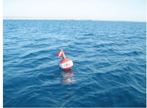
Şekil 3.3. Akıntı ölçümlerinde kullanılan yüzekler (Muhammetoğlu vd 2011)
