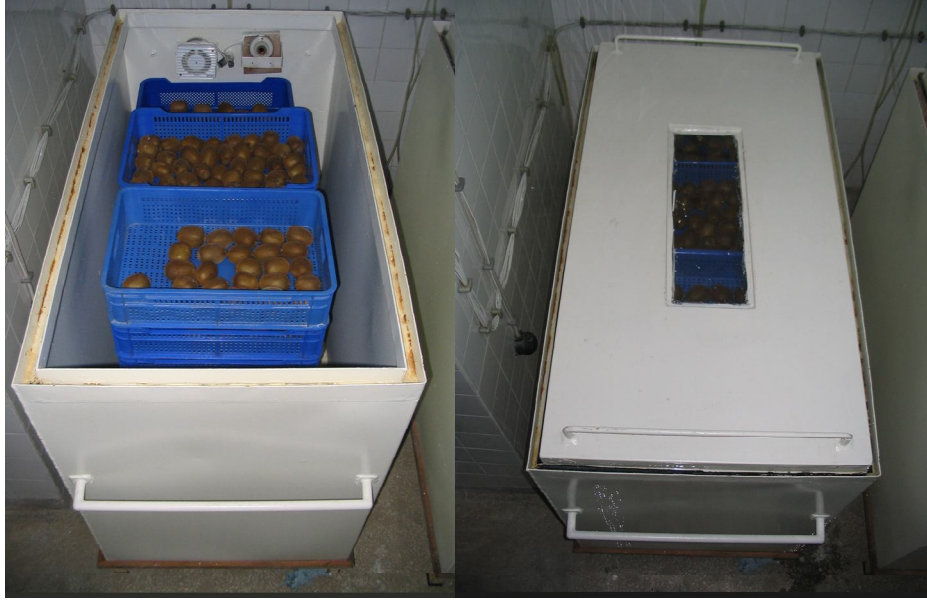
Şekil 3.4. İkinci yıl denemede kullanılan kontrollü atmosfer hücreleri
