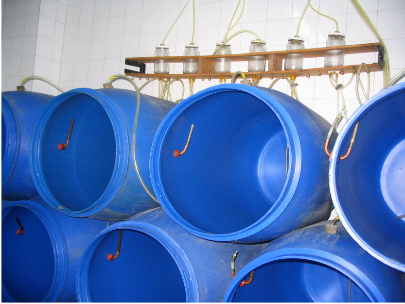
Şekil 3.2. Birinci yıl denemede kullanılan kontrollü atmosfer hücreleri
