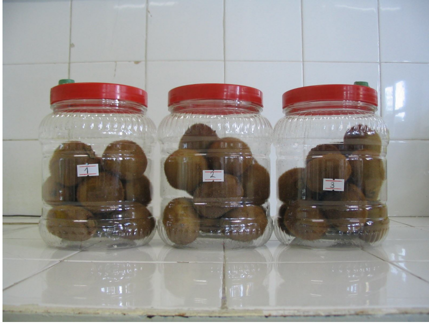
Şekil 3.10. Solunum ve etilen ölçümleri için gaz geçirmez kavanozlarda bekletilen meyvelerin genel görünüşleri
