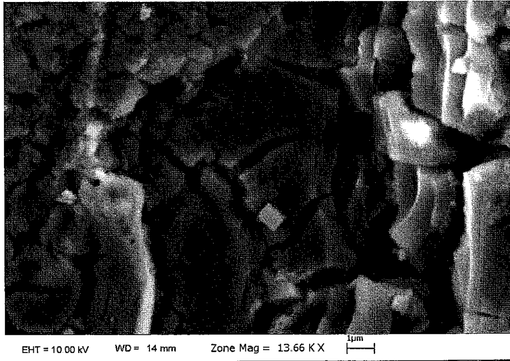
Şekil 4 55 Isıl işlemsiz titreşimsiz numunede darbe testi sonrası kırık yüzey SEM görüntüsü iç kırılmalar 13660x.
