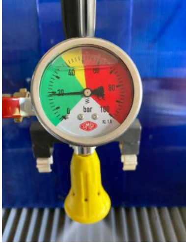
Şekil 3.9. Meme başlığına takılan manometre
