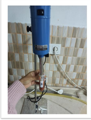
Şekil 3.25. Ultra turrax Janke & Kunkel IKA-Werke marka parçalayıcı
