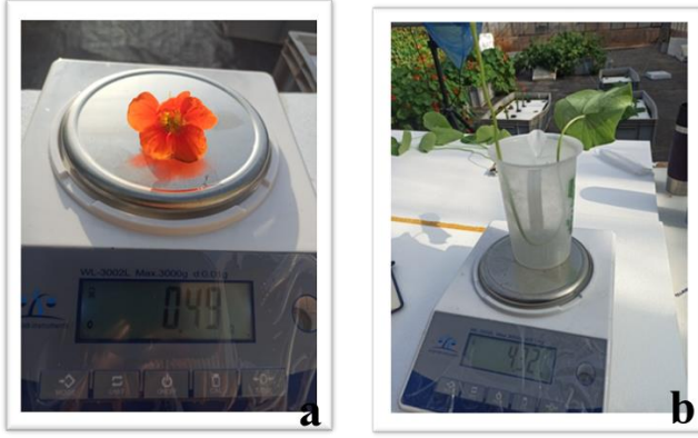
Şekil 3.18. Latin çiçeklerinde çiçek ağırlığının dijital tartıda tartılması (a); yaprak ağırlığının dijital tartıda tartılması (b)
