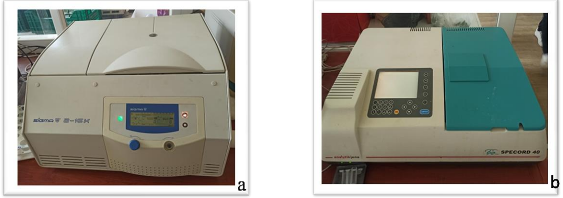
Şekil 3.29. Örneklerin santrifüj edilmesi (a) ve spektrofotometre cihazı ile okutulması (b)
