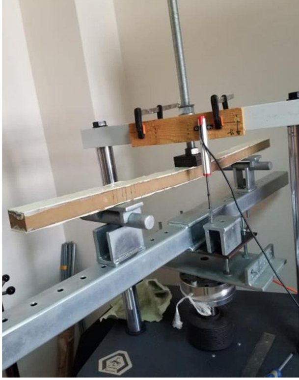
Şekil 4.10. kompozit kiriş 3 nokta eğilme deneyi
