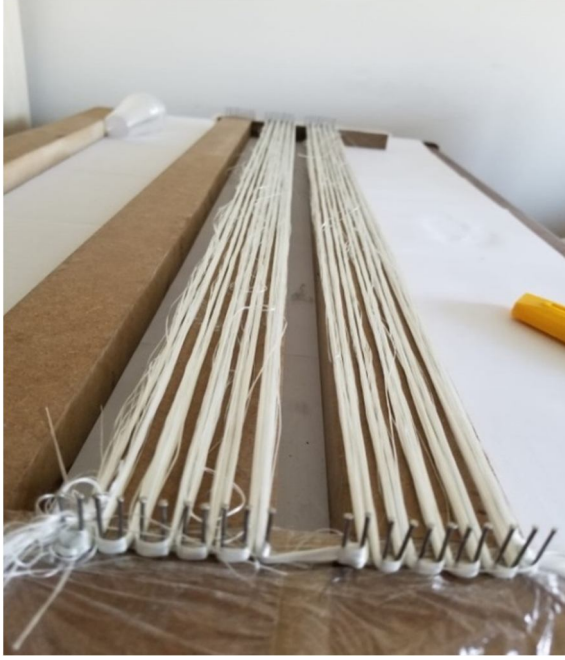
Şekil 4.5. Liflerin kılavuzlar vasıtasıyla yerleştirilmesi
