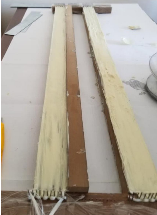
Şekil 4.6. Numune üzerine poliüretan sürülmesi
