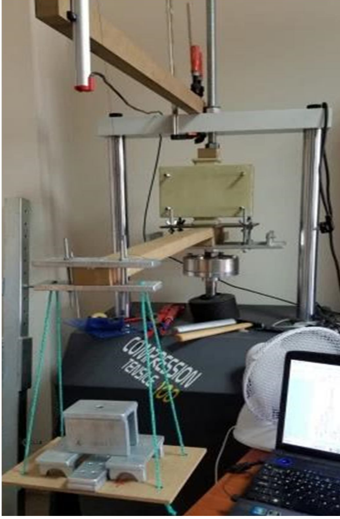
Şekil 3.4. Konsol kiriş statik eğilme deney düzeneği
