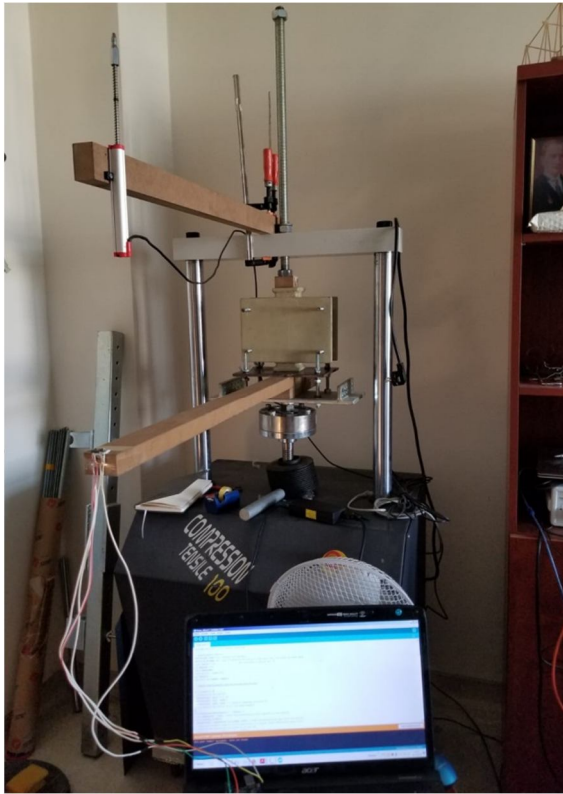
Şekil 3.3. MDF konsol kiriş titreşim testi
