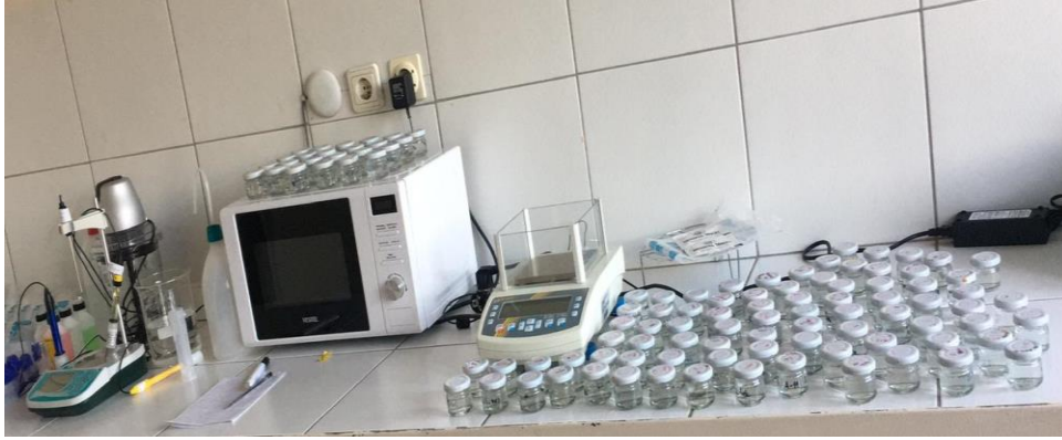
Şekil 3.12. Sıcak su banyosundan alınan örneklerin oda sıcaklığında 25 °C'ye kadar soğuması beklendikten sonra elektriksel konduktivitesinin (EC2) ölçülmesi
