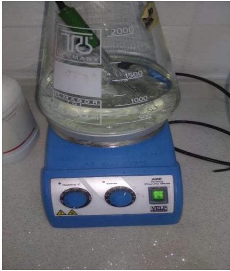
Şekil 3.5. MS ortam pH'sını ölçen pH metre
