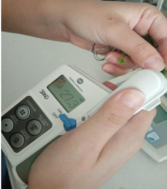
Şekil 3.9. Yaprak örneklerinde klorofil tayini işlemi sırasında bir görüntü
