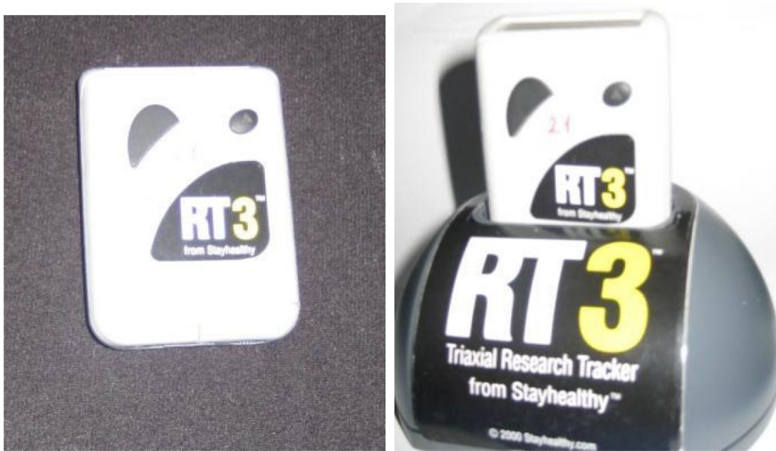
Sekil 3.1. RT3 Tri-axial research tracker ve veri aktarım cihazı (Docking Station)
