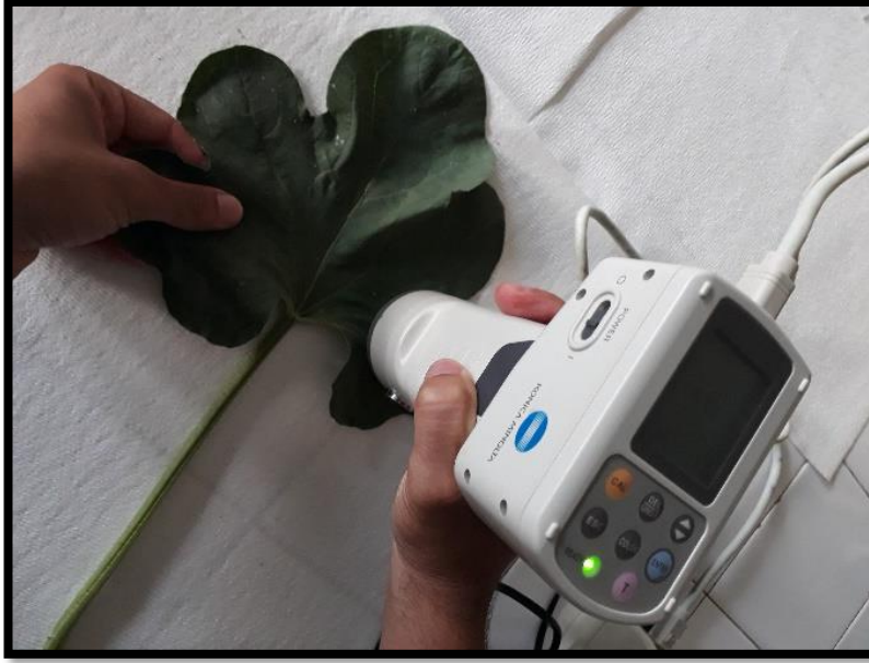
Şekil 3.34. Minolta CR-400 ile yaprakta renk ölçümü
