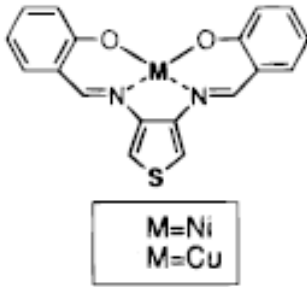
Şekil 2.19. Polimerleşebilir tiyofen omurgası üzerine bağlanmış bis(salisidin) metal kompleksleri (Reddinger ve Reynolds 1998)
