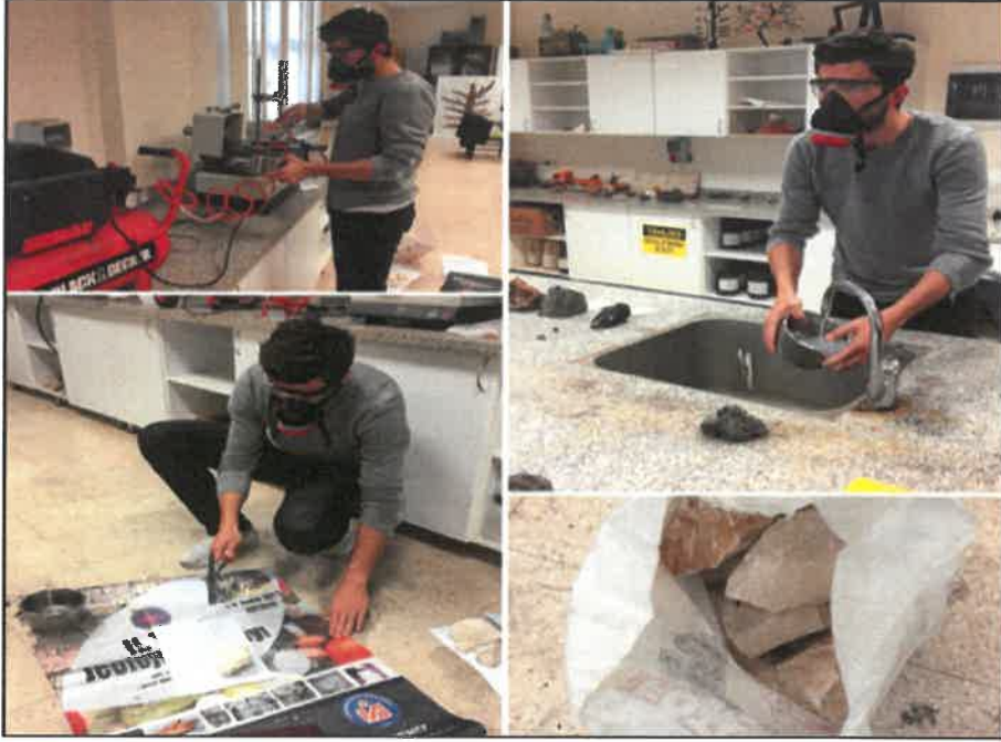
Şekil 3.14. Numunelerin analize hazırlanması kırma-öğütme işlemleri
