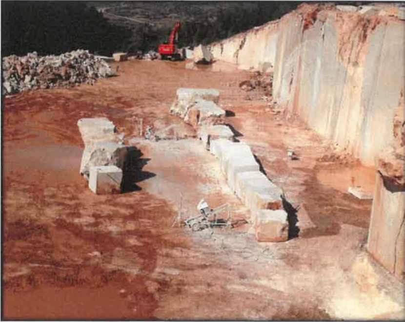
Şekil 3.9. Blok kesmeye yarayan büyük ve küçük motorlar
