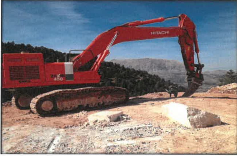
Şekil 3.8. Blok mermerin ayrılmasına yardımcı olan hidrolik prensiple çalışan iş makinesi
