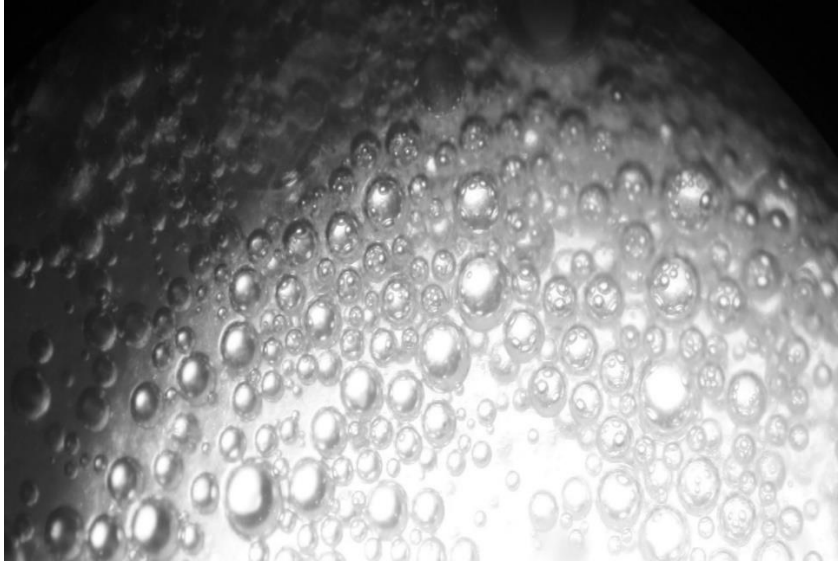
Şekil 4.8. Köpük formunun mikroskop görüntüsü
