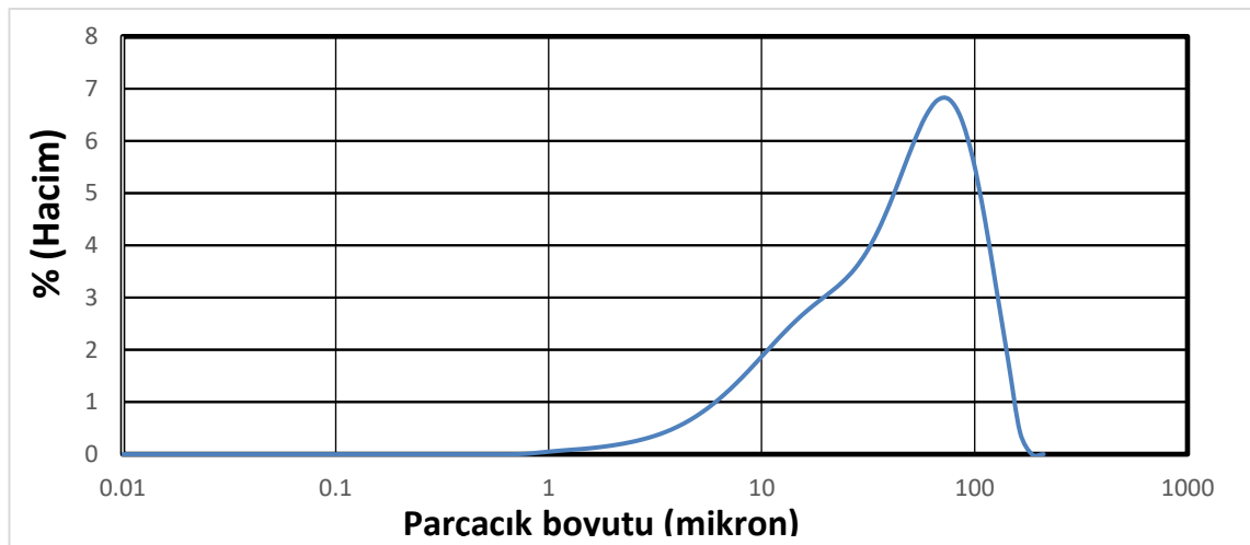
Şekil 4.9. %20 oranında NaCl içeren başlangıç malzemelerinden üretilen \text{Al}_2\text{O}_3\text{-TiB}_2 toz karışımının parçacık boyut dağılımı
