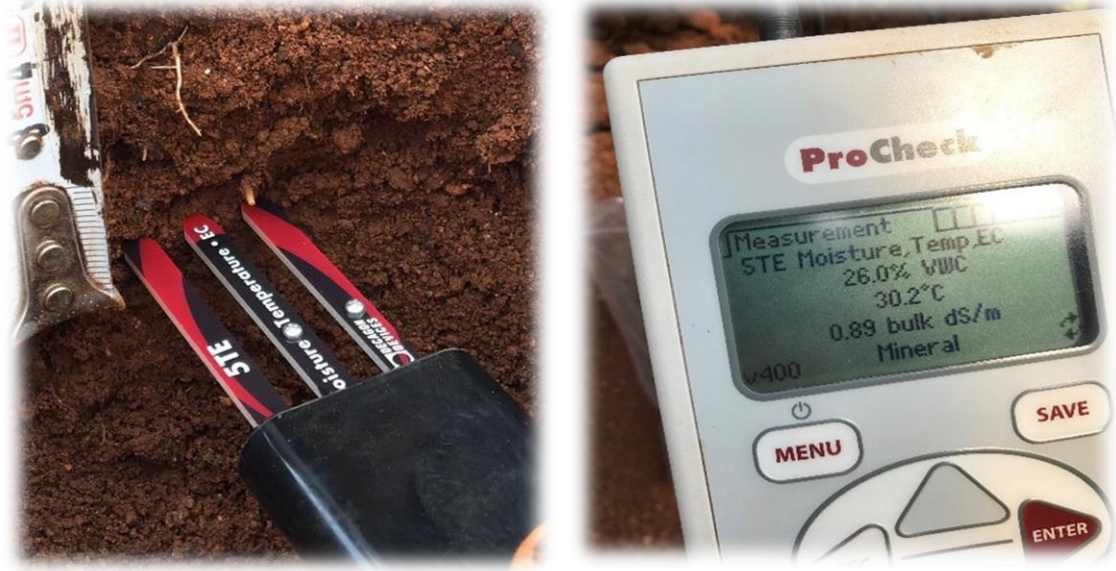
Şekil 3.5. Decagon 5TE cihazı ve problelerinin toprağa yerleştirilmesi
