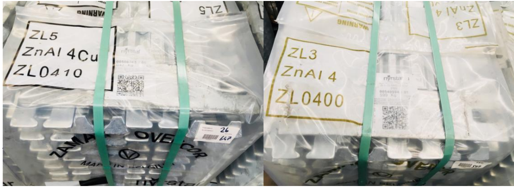
Şekil 3.1. Zamak 3 ve zamak 5 külçeler
