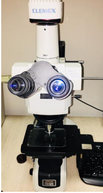
Şekil 3.13. NIKON marka ECLIPSE LV-150 M model optik mikroskop
