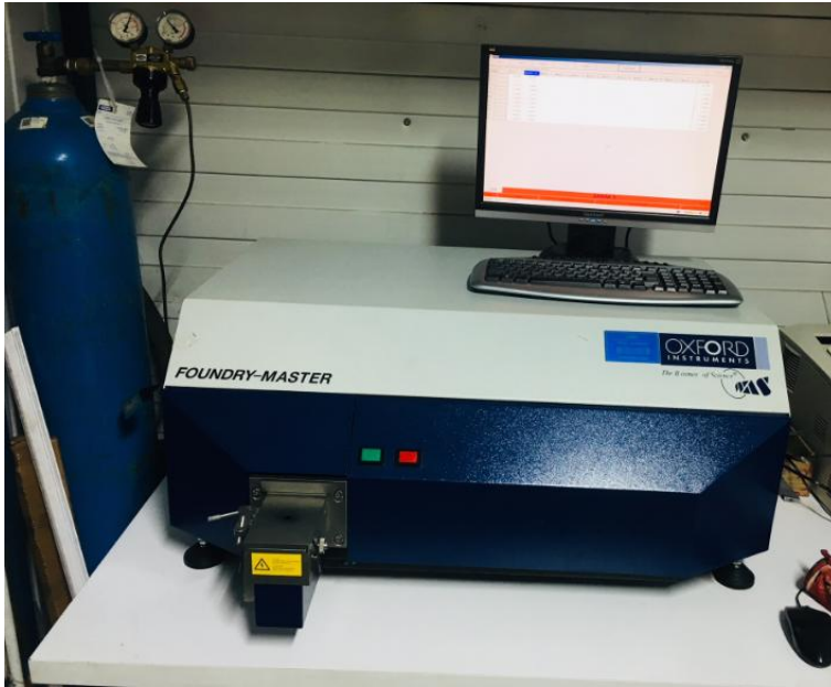
Şekil 3.3. Foundry Master Optik Emisyon Spektrometre
