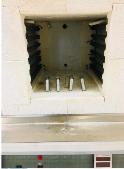
Şekil 3.8. Kül fırınına koyulan numuneler
