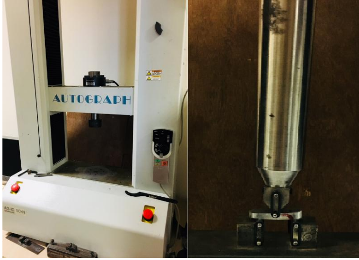
Şekil 3.9. 50kN kapasiteli SHIMADZU AUTOGRAPH AG-IC çekme-basma test cihazı ve üç nokta eğme aparatı
