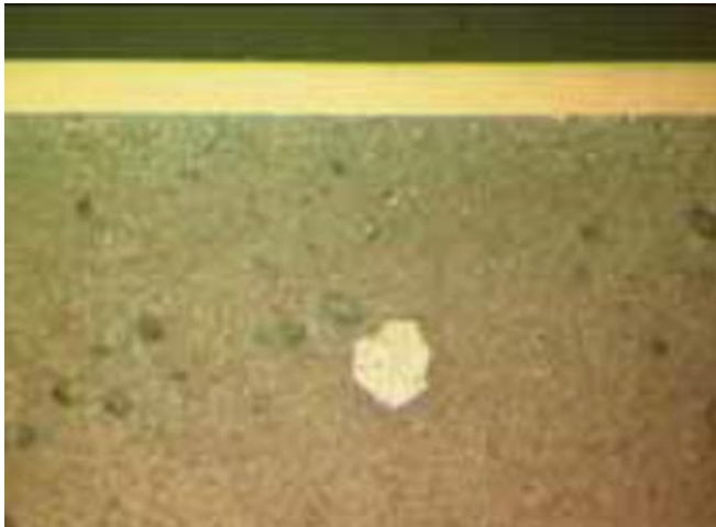
Şekil 2.13. Çinkonun yüksek sıcaklıkta ergitilmesi sonucu alaşım içinde çözünen demir nedeniyle intermetalik oluşumu (Polat 2011b)
