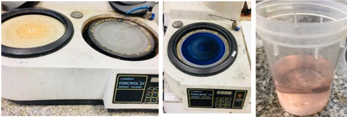
Şekil 3.12. a) Metkon FORCIPOL 2V GRINDER-POLİŞER marka model yüzey polisaj makinesi; b) Metkon FORCIPOL 1V GRINDER-POLİŞER marka yüzey parlatma(polisaj) makinesi; c) Nital Dağlayıcı
