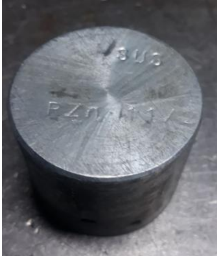
Şekil 3.4. R-Zn11/2 çinko kalibrasyon numunesi
