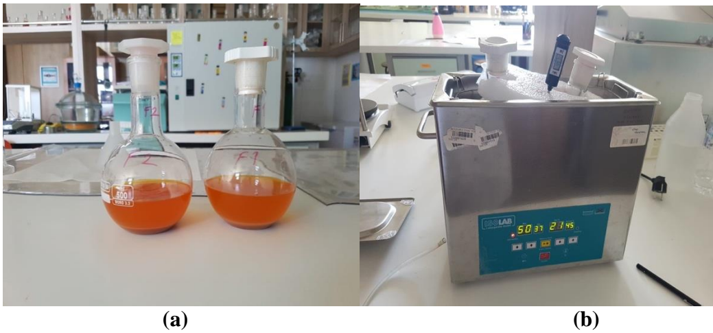
Şekil 3.7. a) Ekstraksiyon öncesi çözügen+karides işleme artığı karışımı; b) Ultrasonik destekli ekstraksiyon
