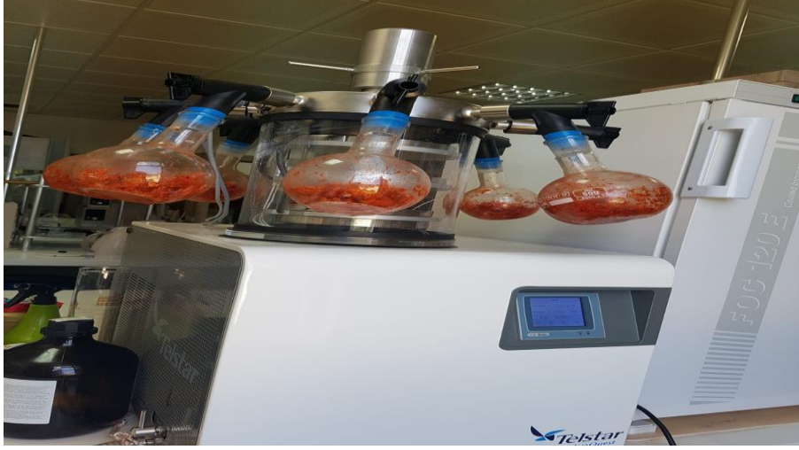
Şekil 3.4. Karides işleme artıklarının dondurarak kurutucuda kurutulması
