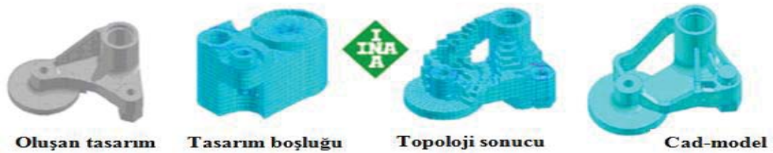
Şekil 3.41. Topoloji optimizasyonu örnek: debriyaj mahfazası tasarımı (Aydoğdu 2015)
