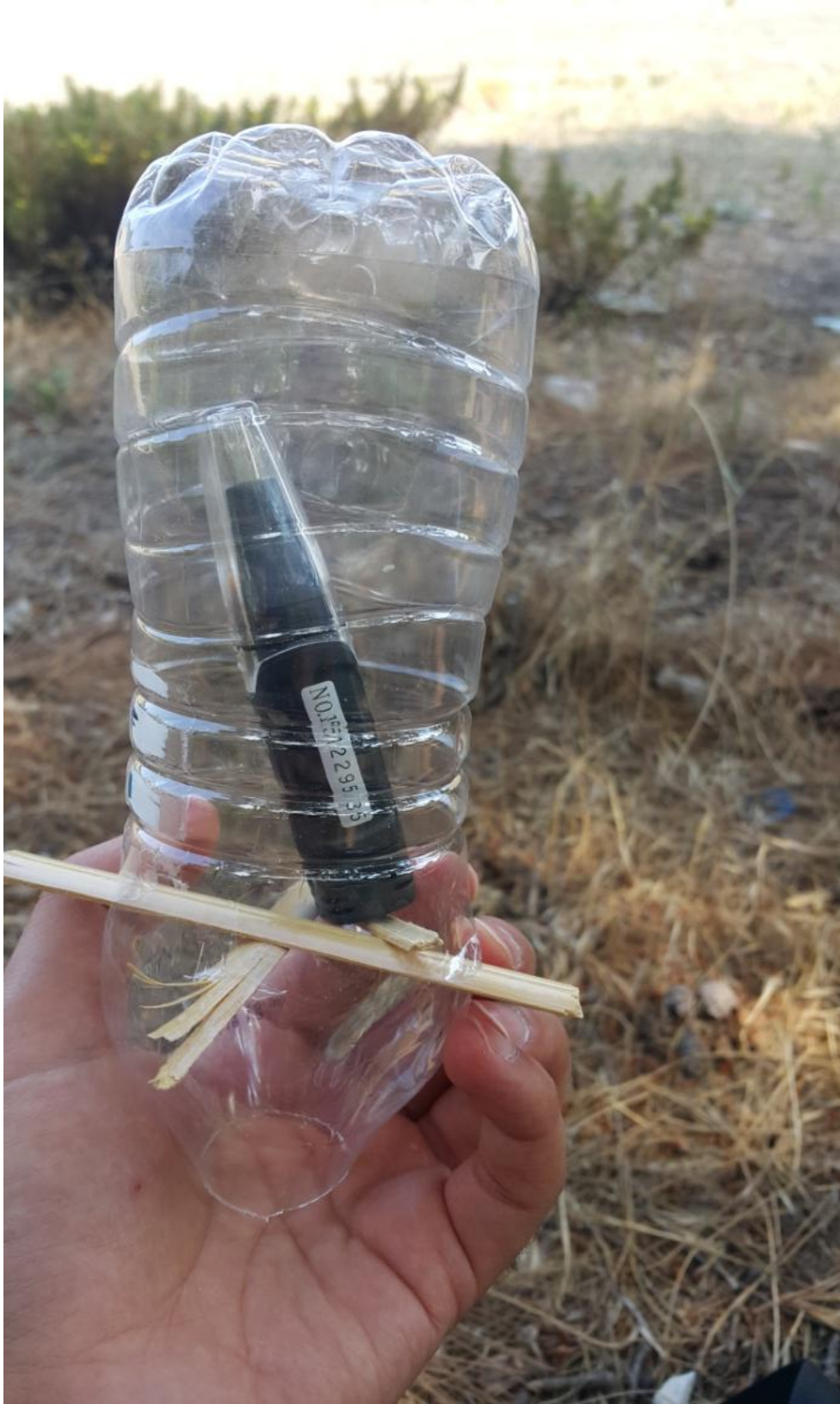
Şekil 3.12. Datalogger cihazını yağmur ve tozdan korumak için alınan basit önlem
