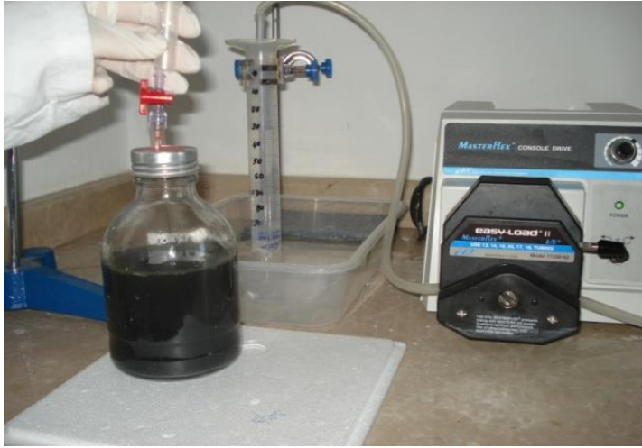
Şekil 3.6. Biyogaz miktarı ölçüm düzeneği
