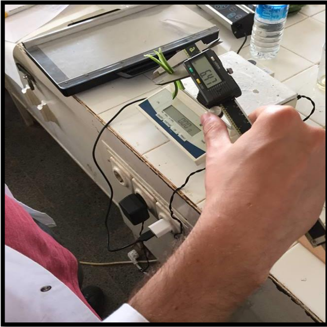
Şekil 3. 22. Sap kalınlığı ölçümü
