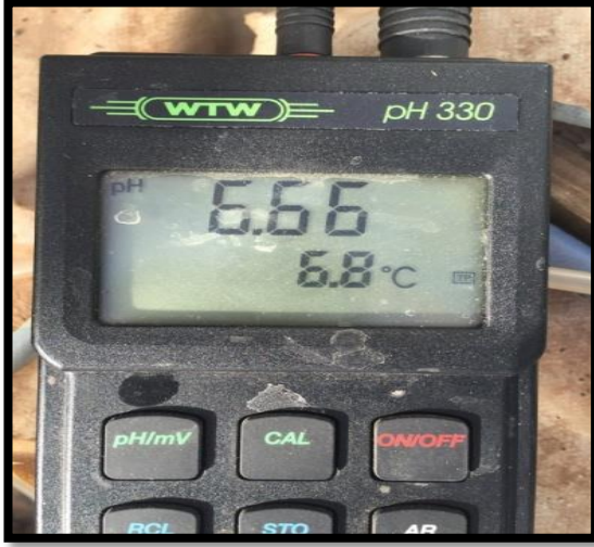
Şekil 3. 29. Solüsyonun pH ve sıcaklık ölçümü
