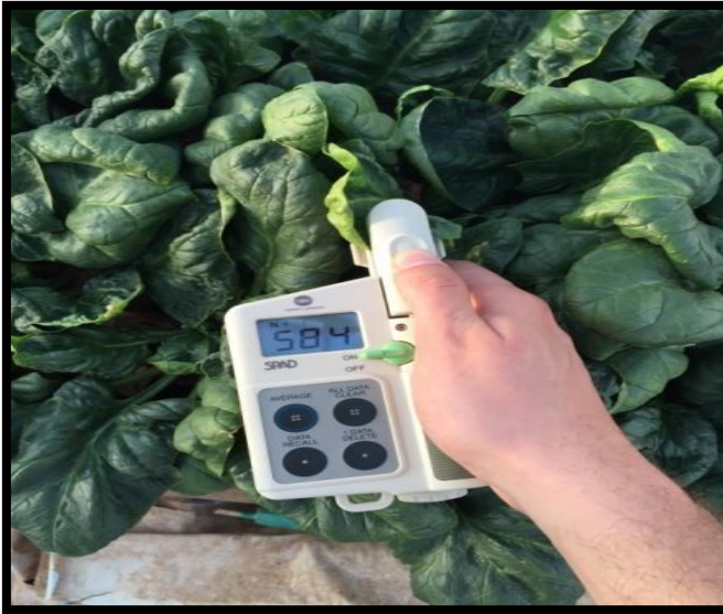
Şekil 3. 28. Yaprak klorofil ölçümü
