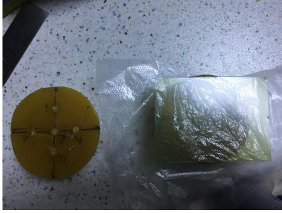
Şekil 3.14. Filmlerin testis yapısına yerleştirilmesi
