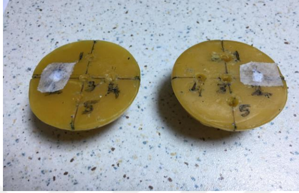
Şekil 3.12. TLD'lerin testis yapısına yerleştirilmesi
