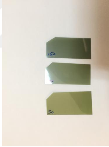
Şekil 2.11. Radyasyon ışınlaması sonrası gafkromik film üzerindeki renk değişimi.
