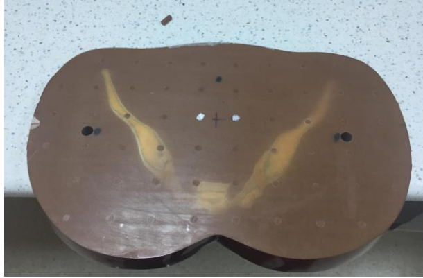
Şekil 3.13. TLD'lerin Rando fantoma yerleştirilmesi
