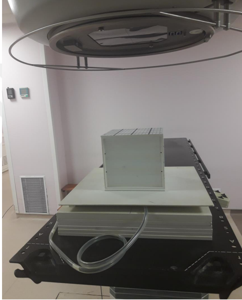
Şekil 3.27. Matrixx ile aynı set-up'ın oluşturulduğu iyon odası ölçüm görüntüsü
