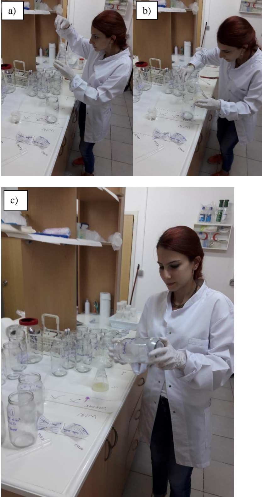
Şekil 3.5. a) Hazırlanan thiamethoxam dozlarının pipet yardımı ile alınması b) Alınan thiamethoxamın kavonazlar içerisine aktarılması c) İçerisine aseton ile thimethoxam konulan kavonazlarda yayma işleminin yapılması
