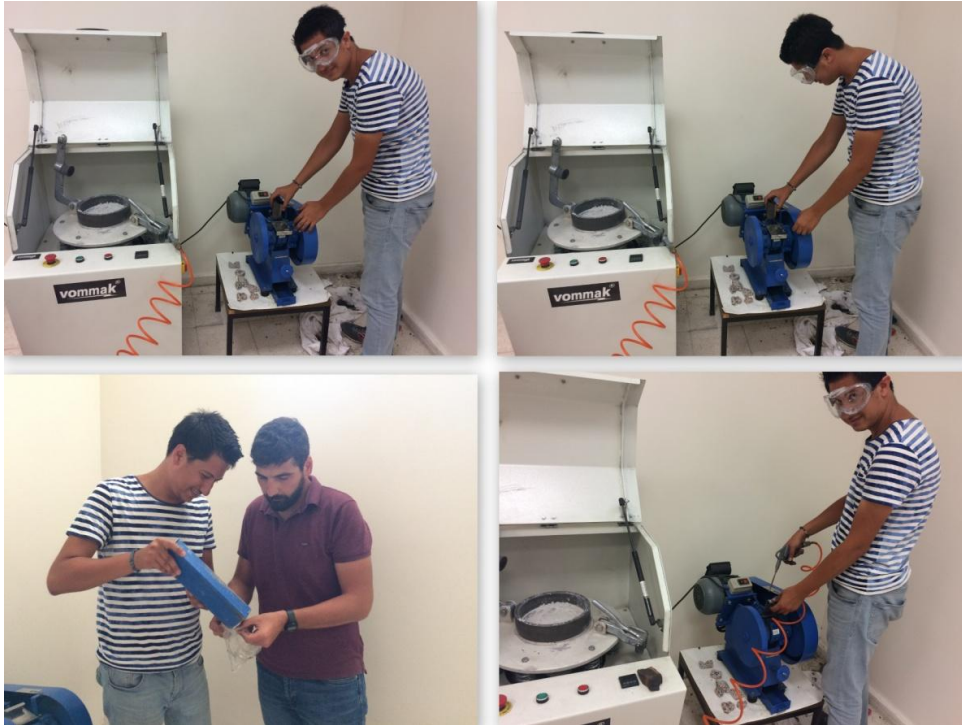
Şekil 3.12. Numunelerin küçük parçalara ayrılması ve temizleme işlemleri
