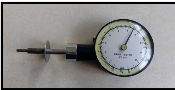
Şekil 3.9. Meyve eti sertliđi ölçümü için kullanılan penetrometre
