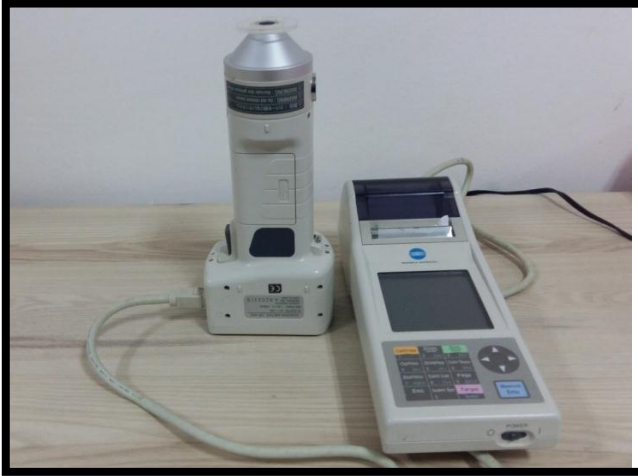
Şekil 3.5. Renk ölçümlerinin yapıldığı Minolta CR-400 cihazı
