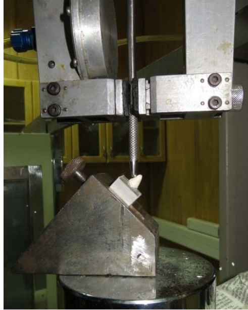
Şekil 2.13. Universal test cihazı ve örneğin kırılma testine tabi tutulması (125)
