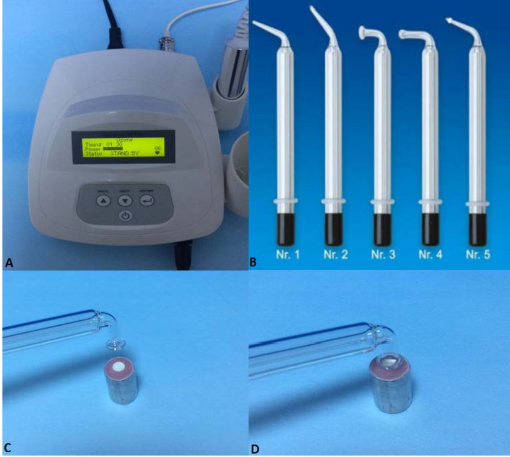
Resim 10. A. Çalışmada kullanılan ozon cihazı. B. Ozon cihazı uçları. Bu çalışmada 3 numaralı uç kullanıldı. C. Örneklere ozon uygulanması. D. Kavite düzeneğinin ozon ucu ile direkt teması.
