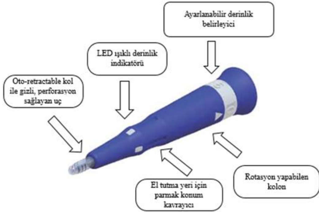
Şekil 3.1 Propel aygıtı ve parçalarının özellikleri (8)
