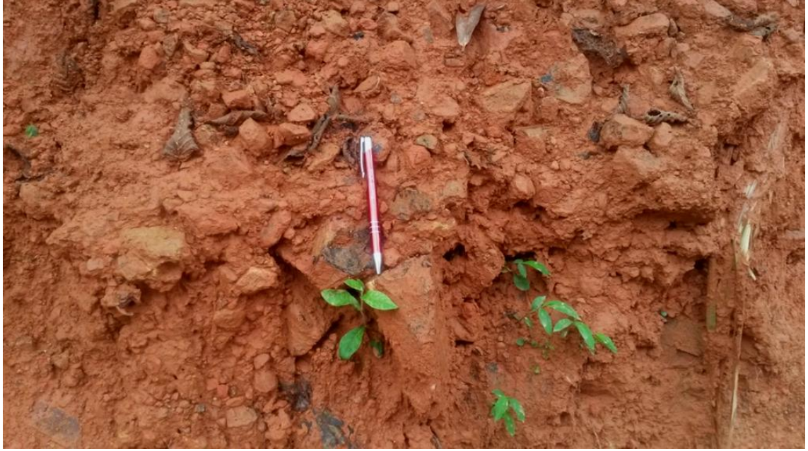
Şekil 3.5. Andezit, bazalt, lav ve piroklast olarak tanımlanan birimin üzerinde izlenen rezidüel seviyenin genel görünümü
