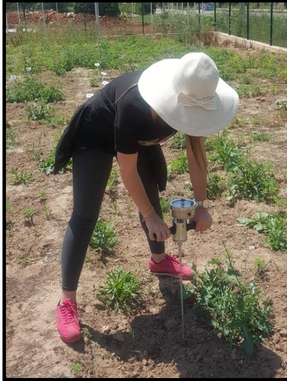
Şekil 3.14. Toprakların penetrometre direncinin belirlenmesi.
