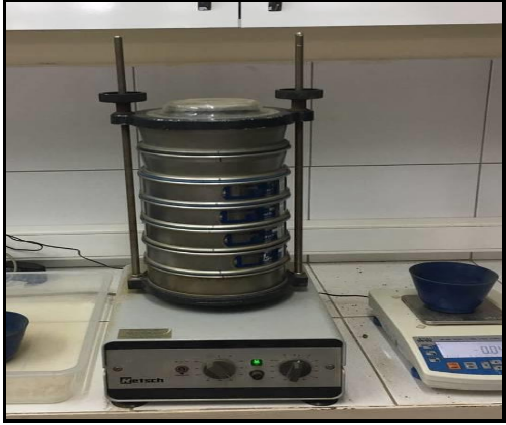
Şekil 3.11. Agregat büyüklük dağılımı analizinde kullanılan Rotar elek takımının görünümü.
