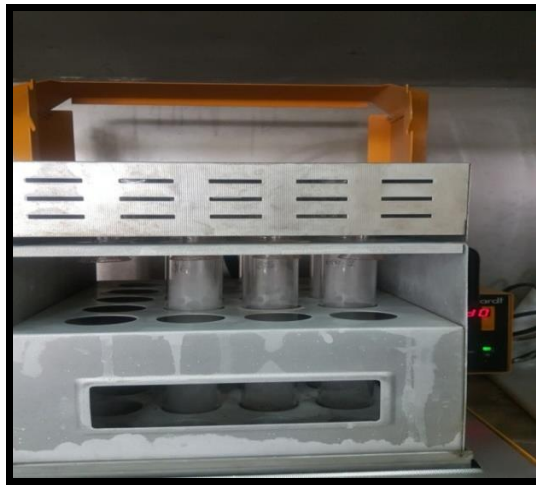
Şekil 3.10. Toprakların N içeriğinin belirlenmesinde kullanılan Kjeldahl yakma setinden bir görünüm.
