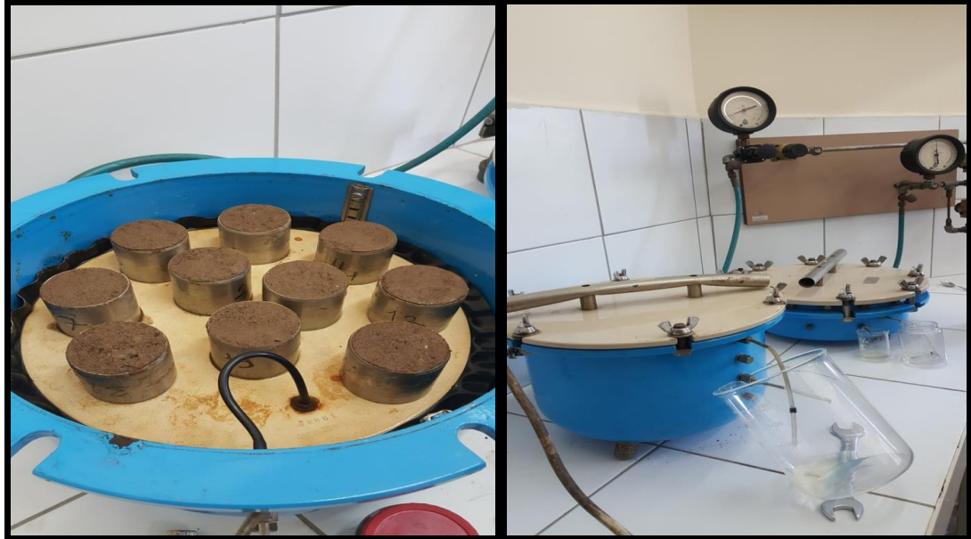
Şekil 3.8. Toprakların tarla kapasitesi ve solma noktası analizlerinin yapıldığı basınçlı tencerelerden bir görünüm.
