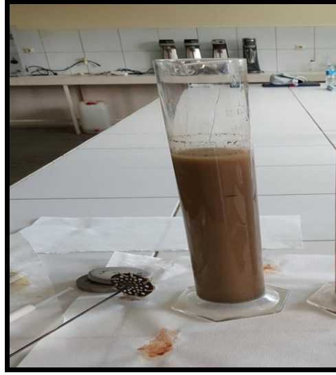
Şekil 3.7. Deneme alanı toprağının tekstürünün Bouyoucos hidrometre yöntemine göre belirlenmesinden bir görünüm
