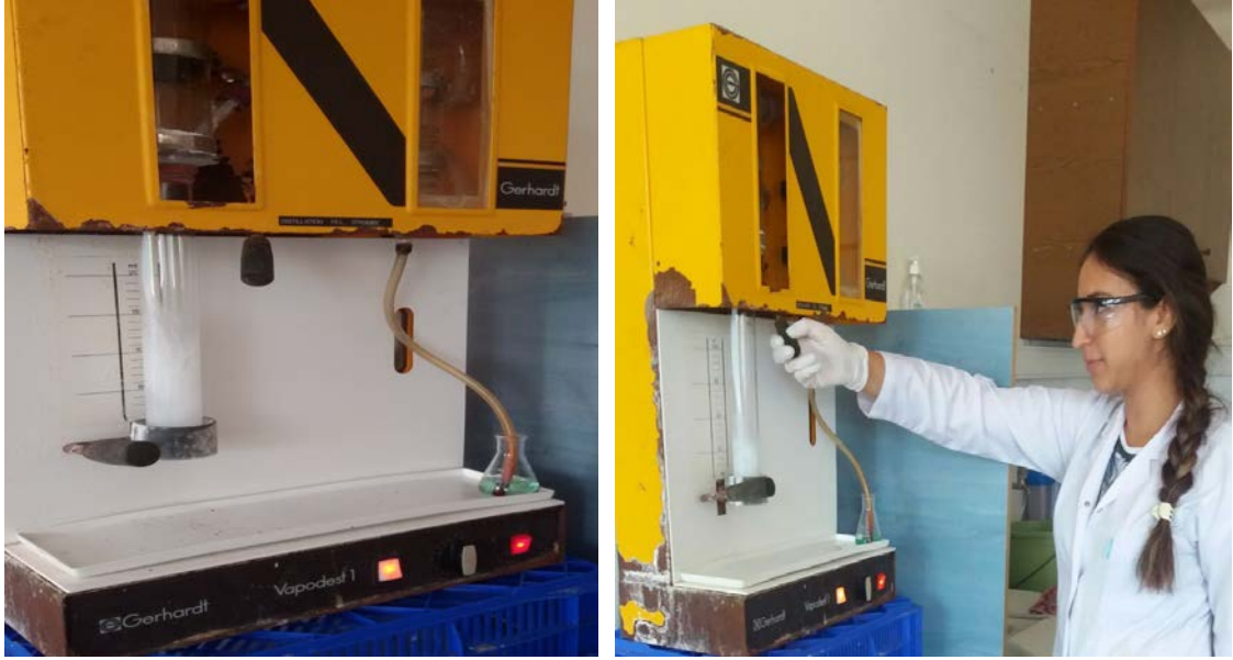
Şekil 3.12. Amonyum ve nitrat azotu analizinin destilasyon aşaması
