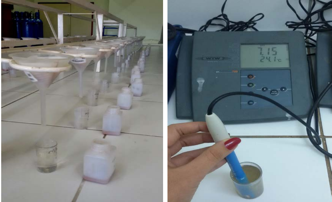
Şekil 3.8. Toprak reaksiyonu tayininde analizin genel görünümü.
