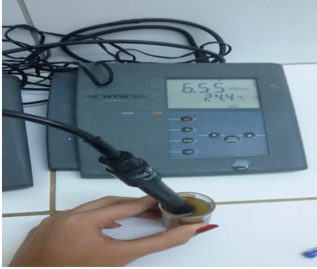
Şekil 3.9. Toprak örneklerinin EC değerleri okunması sırasında genel görünümü.
