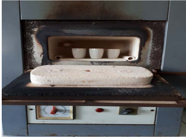
Şekil 3.10. Organik karbon içeriklerinin belirlenmesinde kullanılan kül fırınının görünümü
