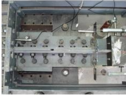
Şekil 3.11. BEÇÇ ve deney düzeneği bağlantısı
