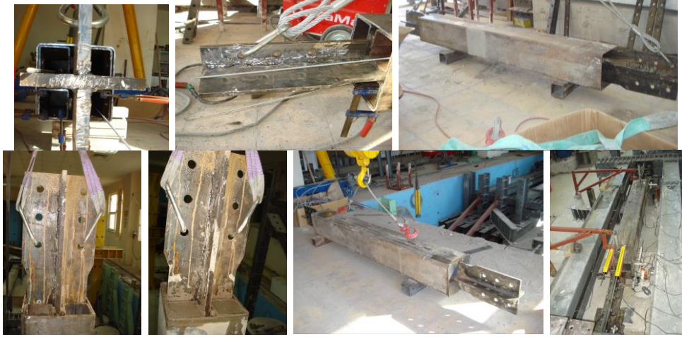
Şekil 3.31. Lama profilli BEÇÇ eleman yapım detayları
