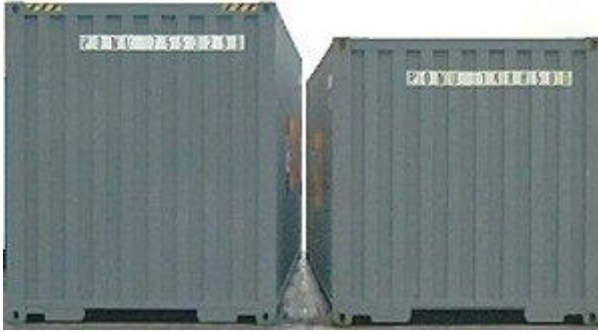
Şekil 3.21 Yüksek Hacimli (High-Cube) Konteyner (9' 6") ile Standart (8' 6") Konteyner Mukayesesi 288
