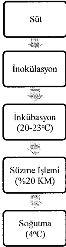
Şekil 3.3. Süzme yöntemiyle konsantre kefirlerin üretim şeması
